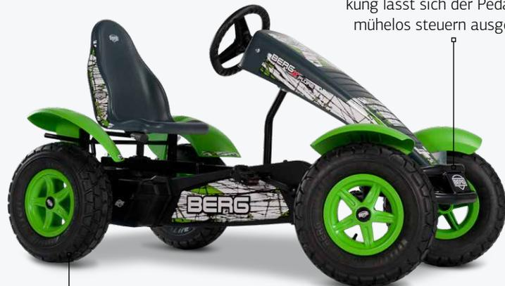
Dank der doppelten Kugelkopflenkung lässt sich der Pedal-Gokart mühelos steuern ausgestattet
